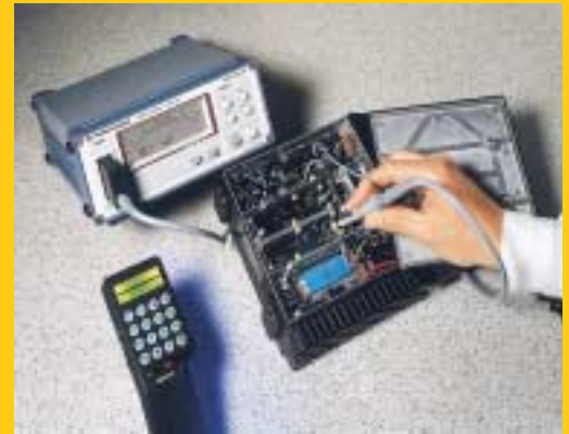
Belastungsarme Spannungsmessung mit HF-Tastkopf URV5-Z7
