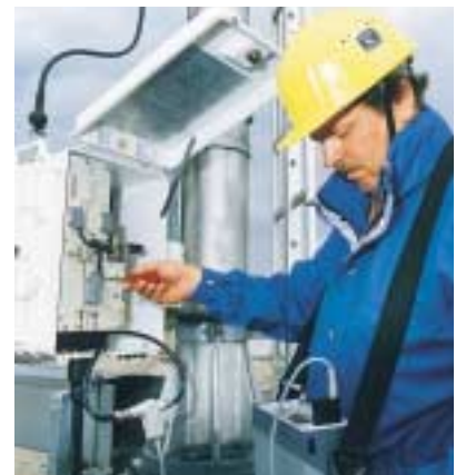
Level Meter URV35 mit Durchgangskopf URV5-Z2 im mobilen Einsatz
